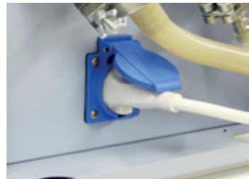
Steckdose zum Anschluss und Steuerung der Vakuumpumpe
