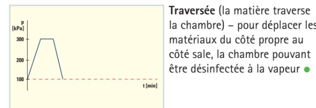
**Traversée** (la matière traverse la chambre) – pour déplacer les matériaux du côté propre au côté sale, la chambre pouvant être désinfectée à la vapeur ●
