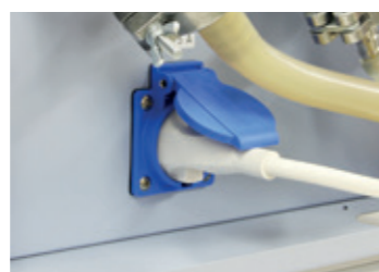
Gniazdko do podłączenia i sterowania pompą próżniową
