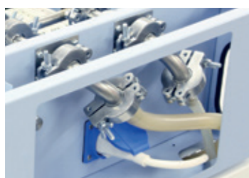
Automatyczna regulacja próżni, włącznie z dwoma kołnierzami DIN 16 i elastycznym silikonowym wężem (Ø 8x18 mm)
